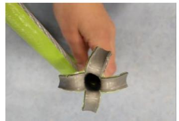
Klebe das Klebeband von innen nach außen, damit es die Öffnung des Schlauchs nicht verschließt.
